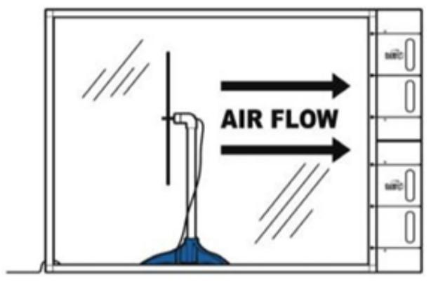
圖 3 風洞內氣流方向示意圖<sup>1</sup>
