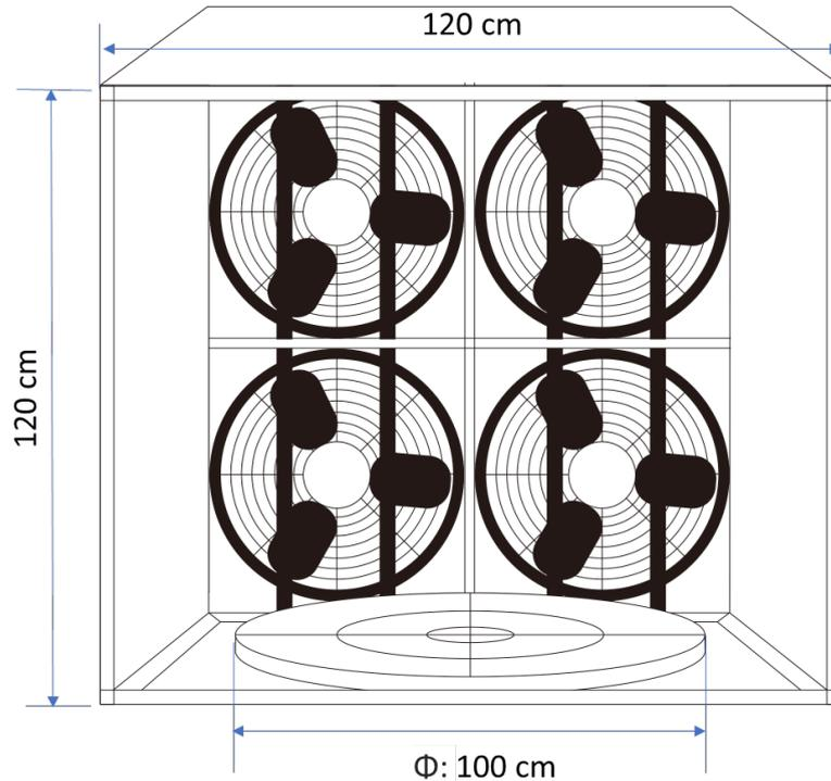
圖 3 轉盤於風洞示意圖
